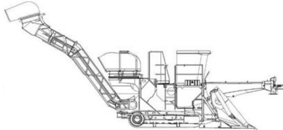
**Colhedora de forragem ou forrageira autoprovelida:** equipamento agrícola automotriz apropriado para colheita e forragem de milho, sorgo, girassol e outros. Executa o corte da planta, sendo capaz de colher ou recolher, triturar e recolher a cultura cortada em contentores ou veículos separados de transbordo.
